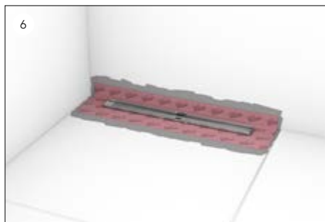
... und die Dichtmanschette eingelegt.
