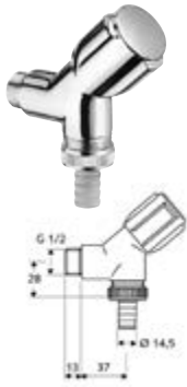
DIANA Geräteschrägsitzventil ohne RB und ASAG mit Rückflussverhinderer und Schlauchverschraubung, Dimension DN 15 G 1/2 AG, verchromt, (DI407911500)
